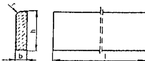
Rysunek 2. Kształt betonowego obrzeża chodnikowego
